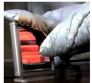
(写真) 電気ストーブに布団が接触して加熱される様子
